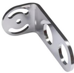
**Opbris Montagewinkel justierbar in einer Achse für gleichzeitige Montage von CT-Messkopf und Visierhilfe mit Loch für Stativbefestigung**
