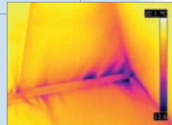
Thermogramm bei Unterdruck während der BlowerDoor-Messung
